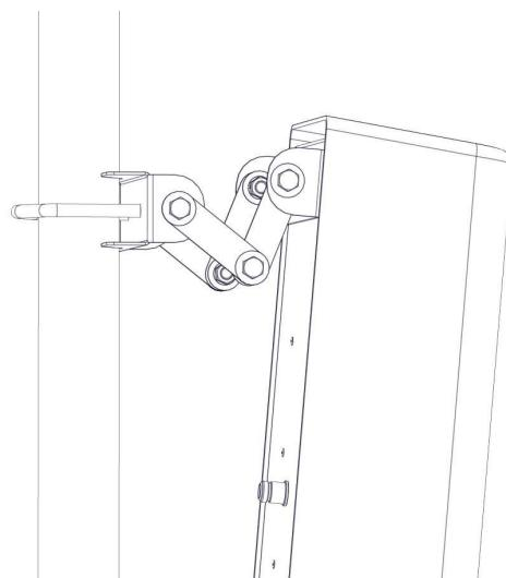
II – Montagem inferior do kit fixação do painel setorial. Utilize peças do KIT118.
