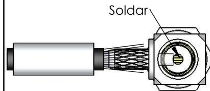
3) Introduzir o cabo no conector ate enconstar o condutor central no pino e soldar.
