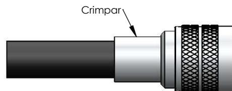
6) Colocar a bucha sobre a malha até encostar no conector e crimpá-la.
