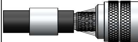
5) Introduzir o cabo no conector colocando a malha sobre a parte recartilhada do conector.
